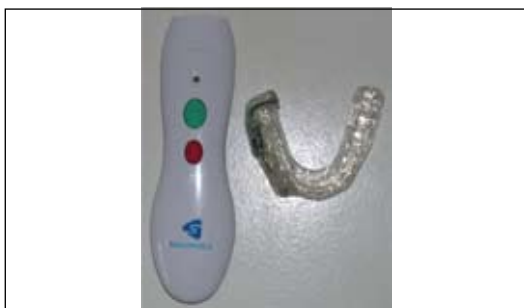
תמונה 2: מכשיר גירוי והשלט רחוק (משמאל). לחיצה על הכפתור הירוק מדליק את המכשיר. בעוד שלחיצה על הכפתור האדום מכבה אותו.
